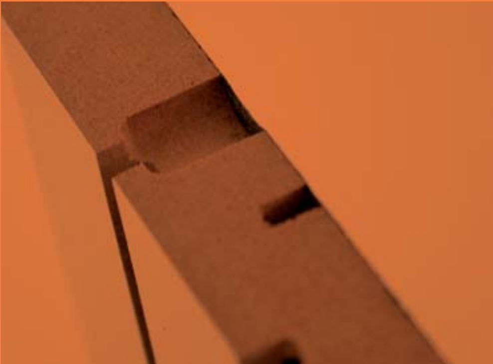
Sezione del risuonatore di Helmholtz nel 4akustik.
